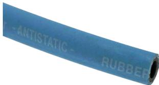
**Werkstoffe:** Innenseele: NBR/SBR schwarz, glatt, antistatisch, Außendecke: SBR/EPDM, glatt, abrieb-, witterungs- und ölbeständig, Gewebeeinlage: spiralisierte, synthetische Textilfäden
