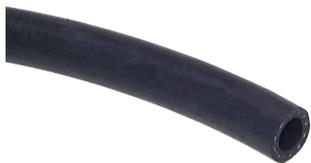
**Werkstoffe:** Innenseele: EPDM, schwarz, glatt, nitrosaminfrei, Außendecke: EPDM, glatt, abriebfest, alterungs- und witterungsbeständig, nitrosaminfrei, Druckträger: hochfeste, synthetische Textilfäden
